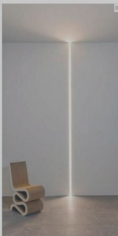
06 // MOONLINE // FRANK SINNAEVE AND STEPHAN GUNST // FLOS // Луч света, прорезающий стену, представляет собой алюминиевый модуль, который монтируется внутри гипсокартона, и блоки светодиодов, крепящиеся к нему на магнитах
